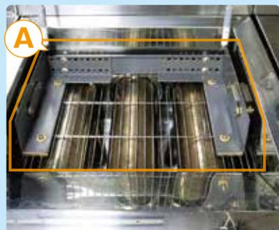
1 左右の電極板と背面プレートをコの字型に組立て
